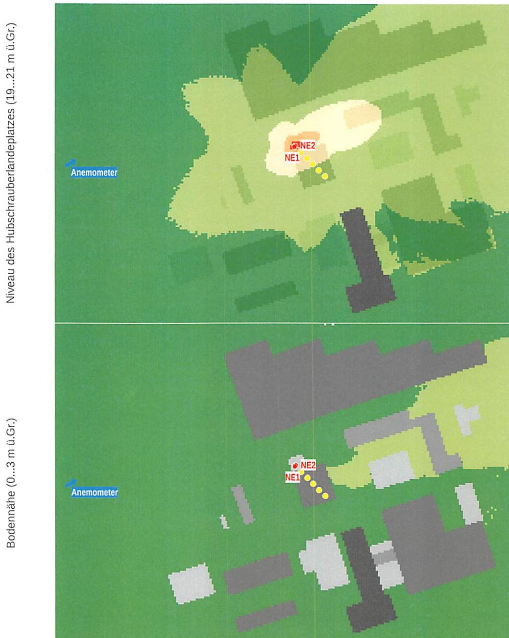
Abb. 8: Anteil des Abgases in der Umgebungsluft bei ganzjährig durchgängigem Betrieb der Netzersatzanlage | Kartenauszug 464 x 320 m<sup>2</sup> von [350864;5634640] bis [351328;5634960] mit Eintragungen der Strömungshindernisse sowie der Positionen der Kamine, der Immissionsnachweisorte sowie des Anemometers für den Antrieb des Prognosemodells | Ausrichtung: Gitter-Nord
